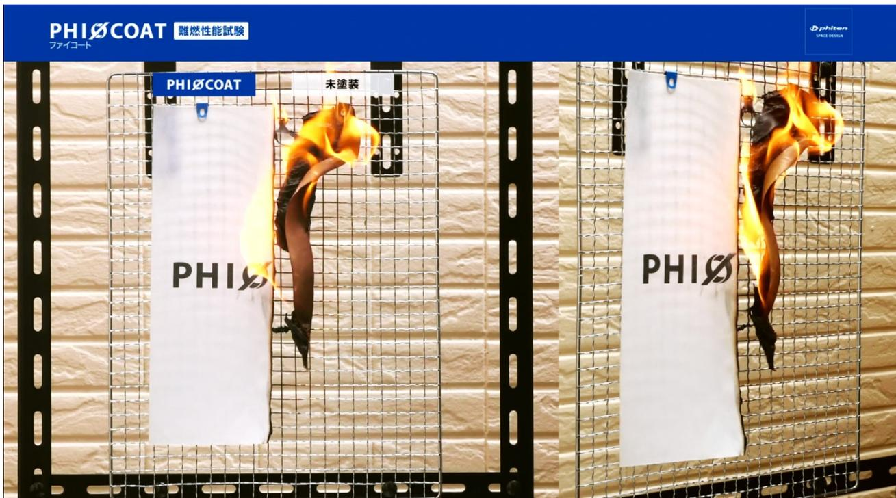
未塗装部分(右側)は勢いよく燃焼しますが、PHIΦCOAT(左側)塗装部分は燃焼しません。
